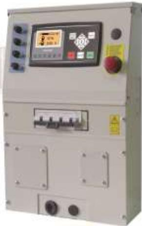
C'est un panneau de commande et de contrôle du générateur, complet avec disjoncteur et câbles de puissance : sa conception fonctionnelle permet de l'installer directement sur le châssis du groupe électrogène.
