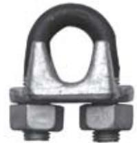
Les serre-câbles doivent être montés sur les câbles métalliques comme indiqué schématiquement sur les figures. Le pont de serrage devra toujours être appliqué sur la partie du câble supportant la charge, l'étrier sur la queue ou sur le bout mort du câble.
