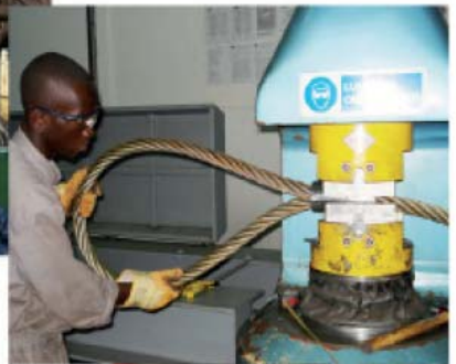
Fabrication des Elingues de levage
